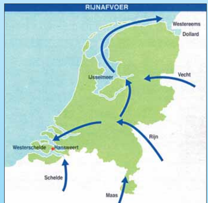
Figuur 7: Problemen met afvoer van het Rijnwater via het IJsselmeer zijn op te lossen door bijvoorbeeld te lozen via Waddenmeer/Dollard naar Westereems en naar de Westerschelde.
